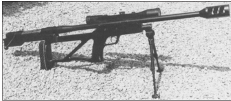
Рис. 8. Хорватская 12,7-мм снайперская винтовка MACS-M3
